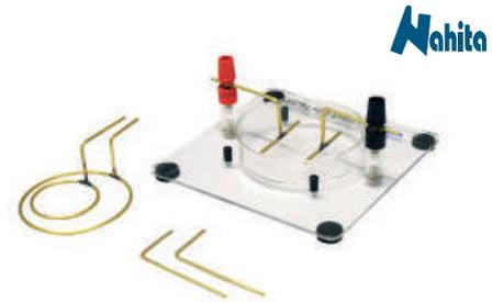
1 | Pour l'étude du champ électrique généré par différentes configurations d'électrodes.
